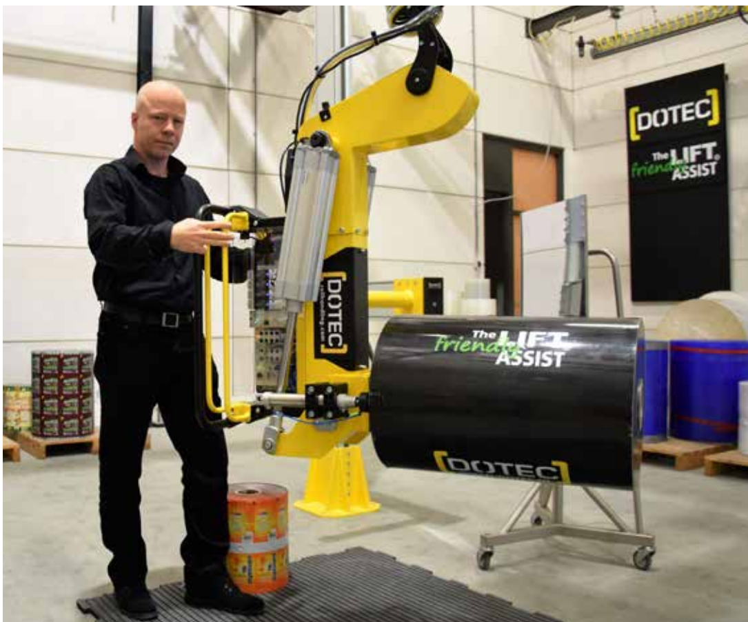
◀ Tilhulp, de rol kan horizontaal en verticaal worden gemanoeuvreed, pilot met Motion Terminal.
